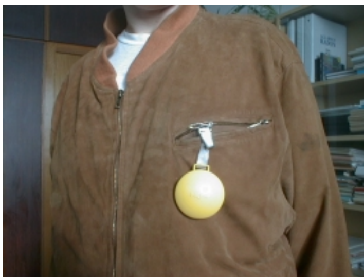
Obr.8.3.1 Osobný dozimeter na sledovanie expozície radónu
