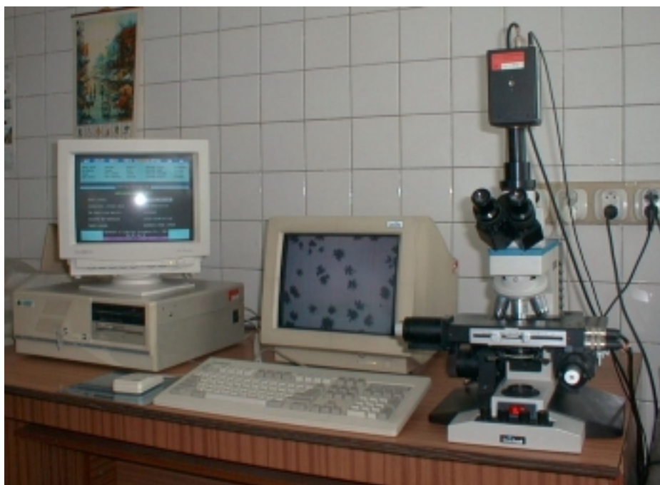
Obr. 6.2.1 Vyhodnocovacia zostava detektorov stôp v pevnej fáze
