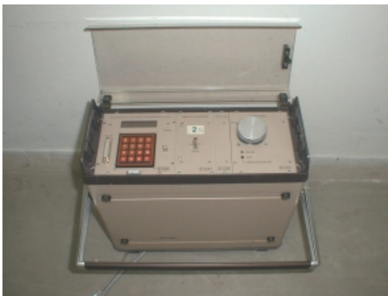
Obr.4.3.1 Štvorkanálové meradlo SILENA 4S dcérskych produktov radónu
