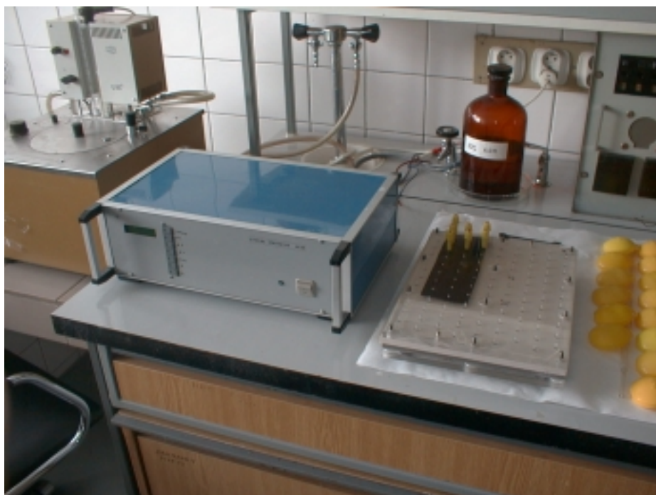
Obr.6.1.2 Aparatúra na elektrochemické leptanie
