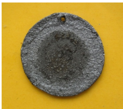
Obr. 2.2.3: Uhlíková platnička termalizátora. V prípade potreby „hrubého terča“ obsahuje terčový materiál. Tmavá škvŕna v strede vyznačuje dopadajúci primárny zväzok.
