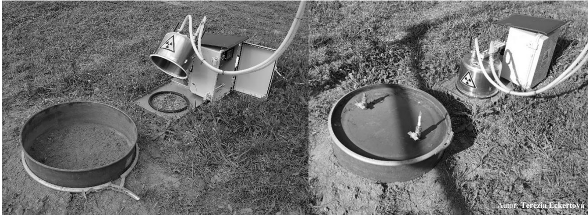
Obr. 13 Fotografia otvorených (vľavo) a zatvorených (vpravo) AN: automatickej akumuláčnej nádoby (AAN) používanej na kontinuálne merania exhalácie ^{222}\text{Rn} a \text{CO}_2 v areáli meteozáhradky a typu AN využívanej pre meraní pred budovou FMFI UK.
