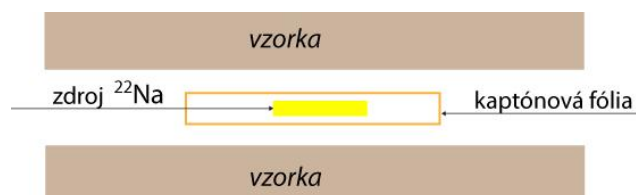
Obrázok 5.2 Sendvičové usporiadanie vzorky a zdroja pozitronov
